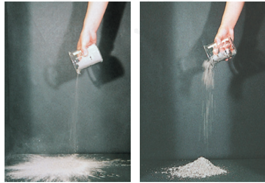
ソリッドエース スーパーソリッドエース 落下による発塵状況の違い
